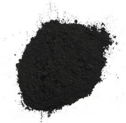
그림 11. 파우더 형태의 활물질과 도전재, 바인더의 혼합체
