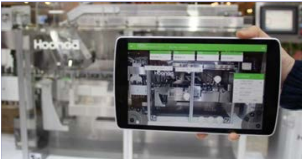
<그림 III-32> 슈나이더 일렉트릭의 AR 기반 IIoT 솔루션을 도입한 흥아기연사의 카톤 포장기
