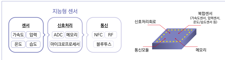
〈그림 III-9〉 스마트 센서 주요 구조
