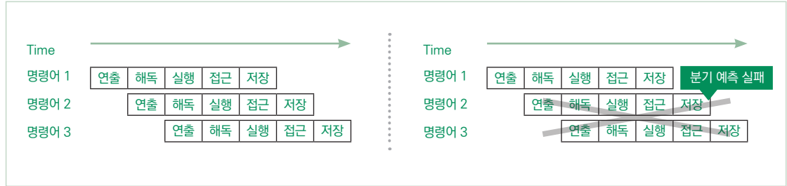
[그림 7-4-2] CPU에서의 명령어 수준 병렬화와 분기 예측 실패 예시
